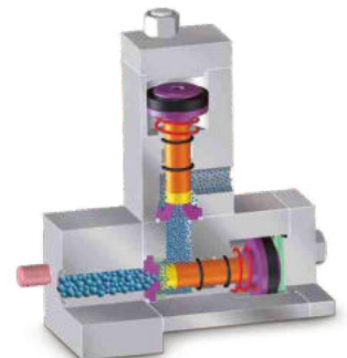
Fase de homogeneización con doble paso.
